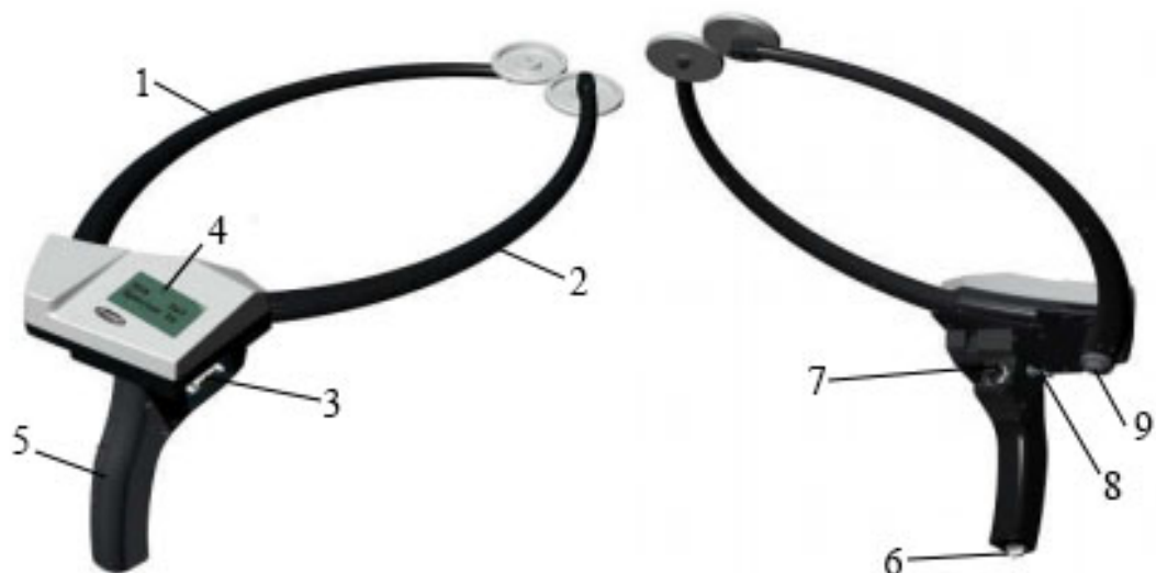
Рис. 2.7. Электронная мерная вилка Masser Racal 500: 1 – подвижная ножка, 2 – стационарная (неподвижная) ножка, 3 – последовательный порт, 4 – дисплей, 5 – ручка, 6 – крышка батареи, 7 – кнопка Enter, 8 – переключатель, 9 – подшипник с пружиной
