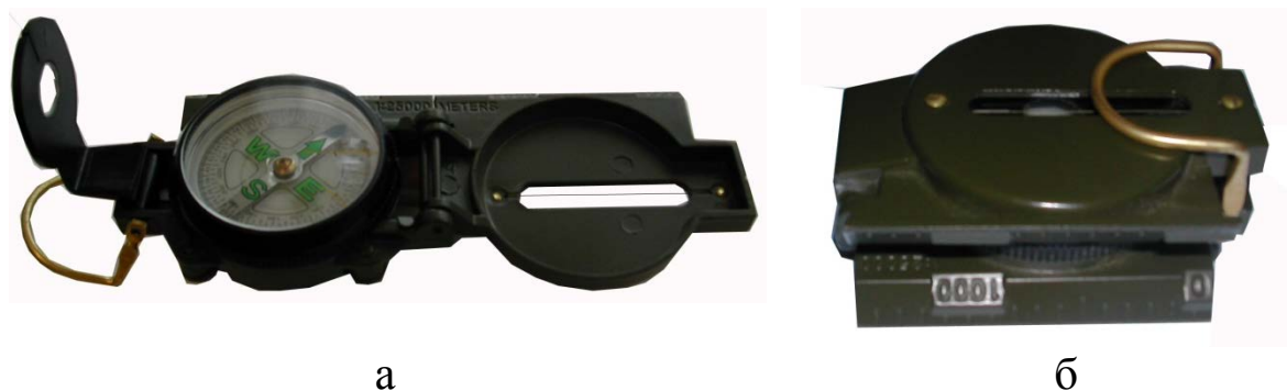
Рис. 1.9. Буссоль-компас (модель 27): а – в развернутом виде, б – в сложенном виде
