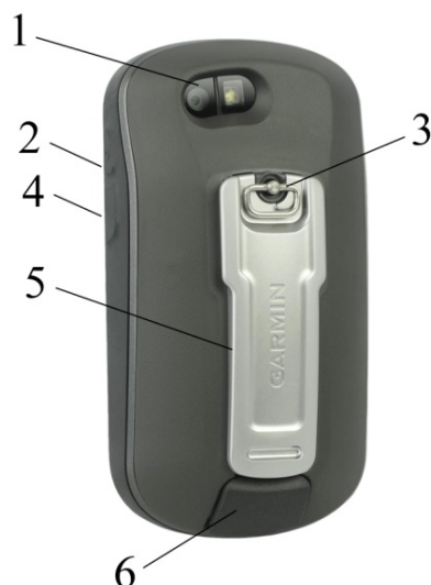
Рис. 10.2. Навигатор Garmin Oregon 650:
