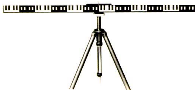
Рис. 5.8. Базисная линейка на штативе
