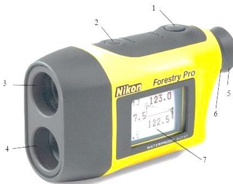
Рис. 3.34. Лазерный дальномер-высотомер Nikon Forestry 550 PRO: 1 – Power (питание), 2 – Mode (режим), 3 – линза монокулярного объектива / отверстие лазерного излучателя, 4 – отверстие приемника излучения, 5 – наглазник/кольцо регулировки диоптрии, 6 – монокулярный окуляр (6-кратного увеличения), 7 – внешний ЖК-дисплей
