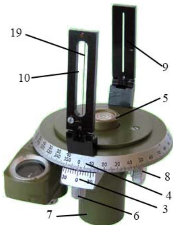
Рис. 1.6. Буссоль АР-1: 3 – верньер, 4 – лимб, 9 – глазной диоптр, 10 – предметный диоптр, 5 – уровень, 6 – фиксатор, 7 – штырь, 8 – закрепительный винт
