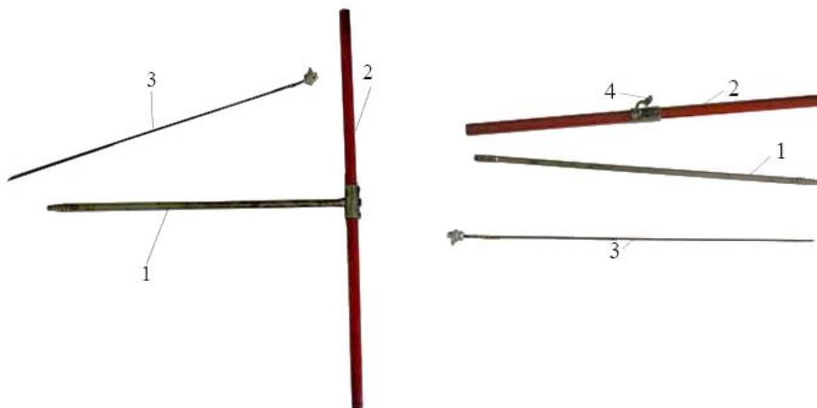
Рис. 7.1. Возрастной бурав: 1 – бурав, 2 – футляр-вороток, 3 – экстрактор, 4 – защелка
