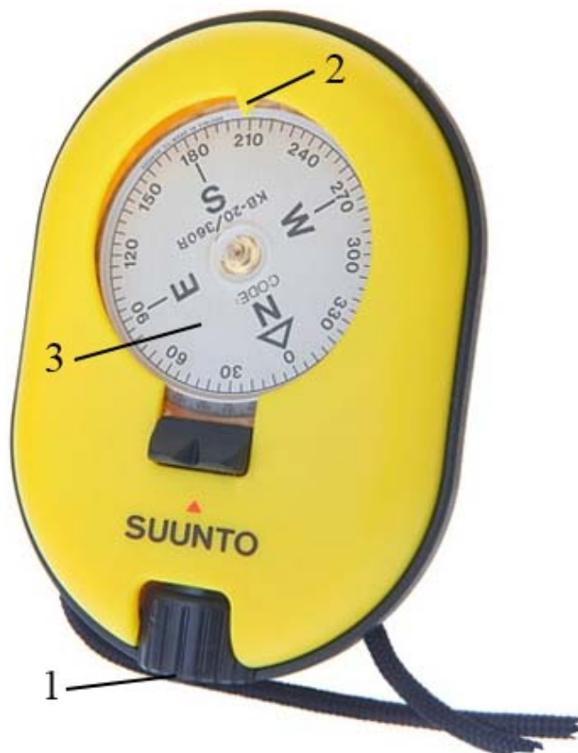
Рис. 1.11. Буссоль SUUNTO KB-20: 1 – оптика, 2 – азимутальный лимб, 3 – диск компаса
