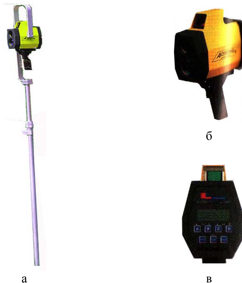
Рис. 1.8. Буссоль лазерная: а – буссоль на штативе, б – общий вид, в – вид спереди
