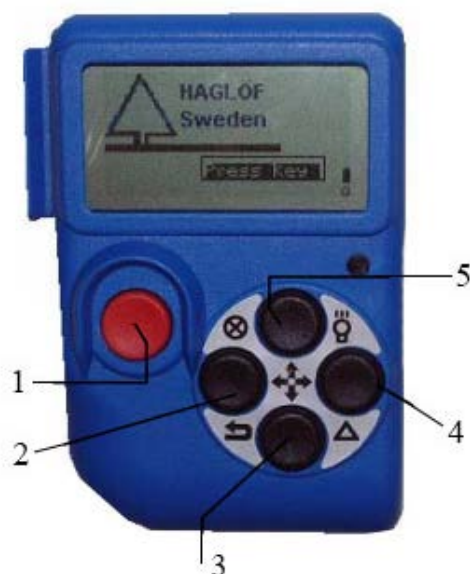
Рис. 2.11. Кнопки компьютера мерной вилки: 1 – ввод, 2 – влево, 3 – вниз, 4 – вправо, 5 – вверх
