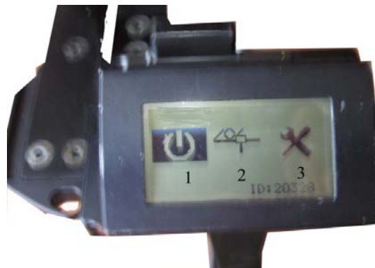
Рис. 2.9. Экран мерной вилки Masser BT Caliper с кнопками режимов: 1 – включение-выключение, 2 – измерения, 3 – настройка
