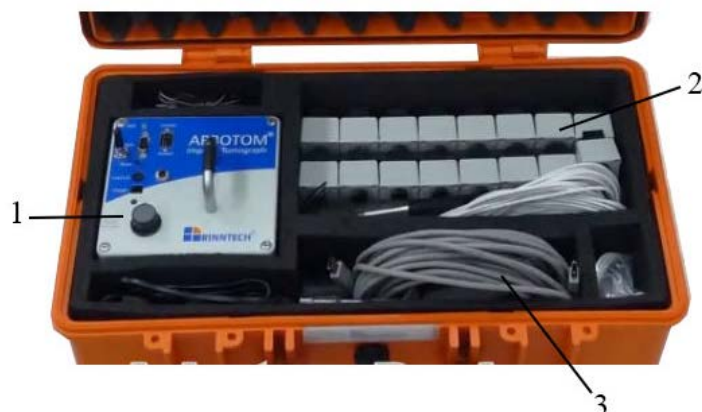
Рис. 9.4. Импульсный томограф Арботом: 1 – системный блок, 2 – датчики (сенсоры), 3 – соединительные провода
