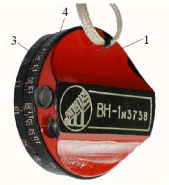
Рис. 3.14. Общий вид высотомера ВН-1 (пояснение к цифрам дано на рис. 3.15)
