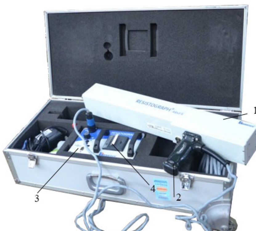
Рис. 9.2. Резистограф: 1 – тубус, 2 – рукоятка, 3 – системный блок, 4 – термопринтер с термобумагой
